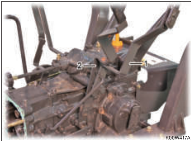
8. Remove the PTO shift lever (1) and range shift lever (2).
